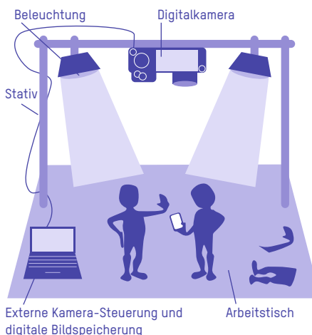
Abb. 2: Schematischer Aufbau eines Legetrickstudios (links) und einer kostengünstigen Alternative (rechts)
